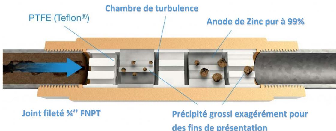
1- En circulant l'eau subit des changements de pression rapide créant de la cavitation ce qui fait se précipiter ou débiter une cristallisation (la nucléation) des ions calcaire. Ils sortent ainsi de l'eau et ne sont donc plus en solution dans l'eau mais en suspension (colloïde).
